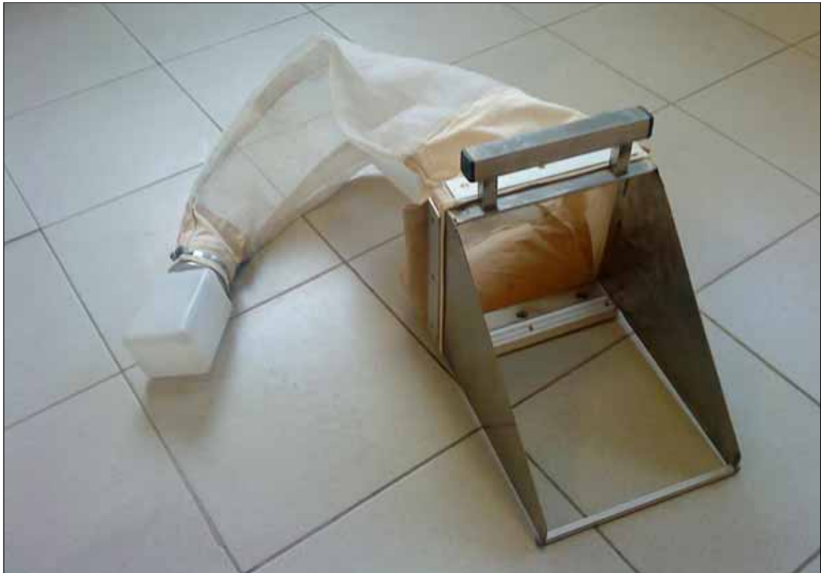
Rete surber con telaio anteriore delimitante 0,05 m 2
